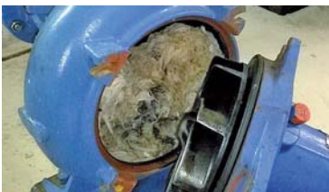
Defekte Pumpe! Verstopft mit Feuchttüchern!
